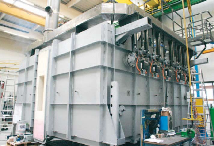
Drehherdofen – in Montage vor der Auslieferung
