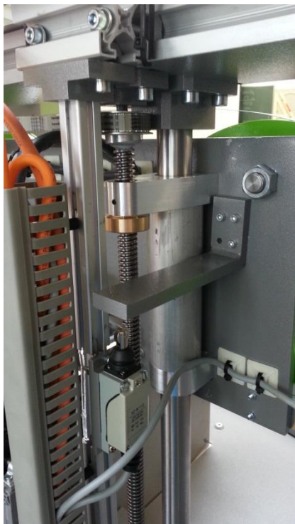
Senken des Sägemoduls über Bewegungsspindeln in Gewindemuttern
