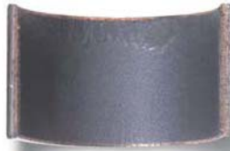
Beginnende Delamination (Standardwerkstoff)
