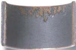
Starke Delamination (Standardwerkstoff)
