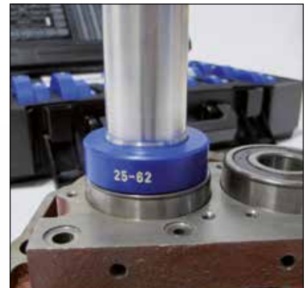
Die Nummern der Anschlagringe sind deutlich graviert und farbig, so dass Irrtümer ausgeschlossen sind.
