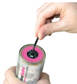
Laufzeit mit 3 mm Innensechskantschlüssel aktivieren
