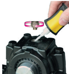
Reduziernippel einschrauben (Wenn nötig, Schmierstelle abdichten)
