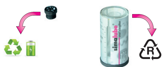
Antriebskopf zerlegt im Batterie-Recycling und leeres Gehäuse im Kunststoff-Recycling entsorgen
